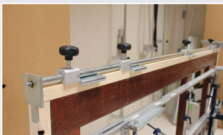
Afb. 2 Aanslagblok tegen bovenzijde scharnierblad
