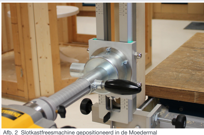
Afb. 2 SlotkastfreesmACHINE gepositioneerd in de Moedermal
